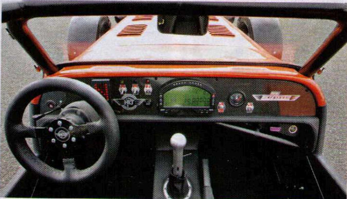
Cockpit: mittig die Acht-Kanal-Datenaufzeichnung, Standard im Clubsport
