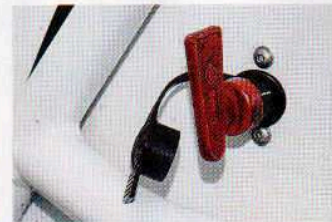
Der Not-Aus-Schalter dient im Alltag auch als Wegfahrsperr
