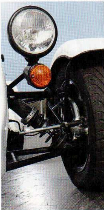
Doppelte Dreiecksquerlenker, Bilstein-Eibach-Gewindefederbein
