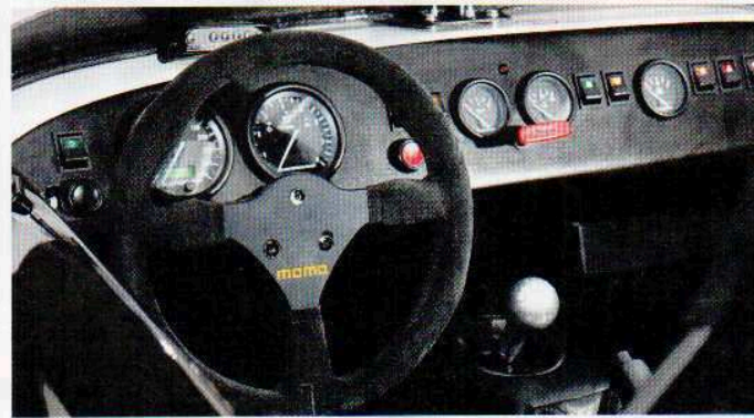
Das winzige Wildlederlenkrad ist extrem griffig, die verstreuten Schalter und Tasten erfordern Übung. Der rote Griff in der Mitte aktiviert die Löschanlage
