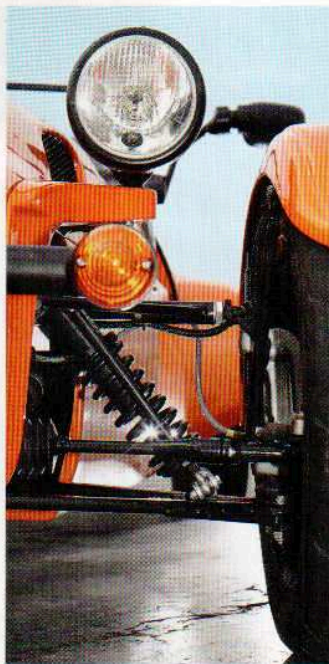
Auch Westfield verwendet einstellbare Gewindefederbeine
